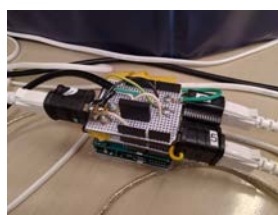
図8 複数台の給餌器を制御可能な給餌器作動部
