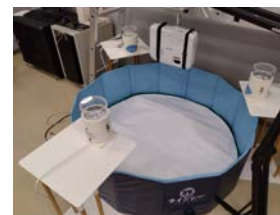
図9 実給餌器で構成した給餌シミュレータ
