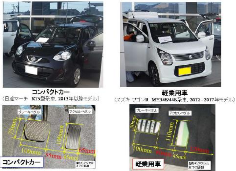
図2 実験に用いた試験車とそれぞれのペダルの配置 (水平方向)
