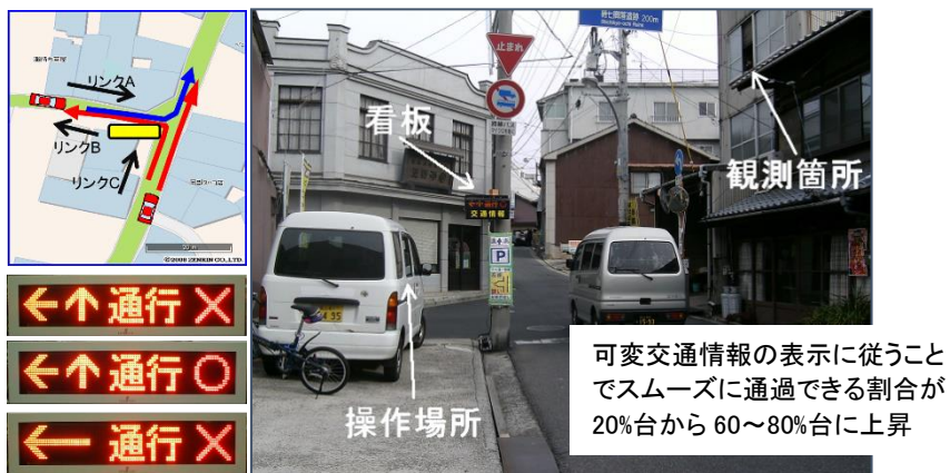
図 4. 可変交通情報看板の表示例と実験の様子（小林講師の研究報告より）
