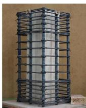
写真 1 WRC2 試験体配筋状況
