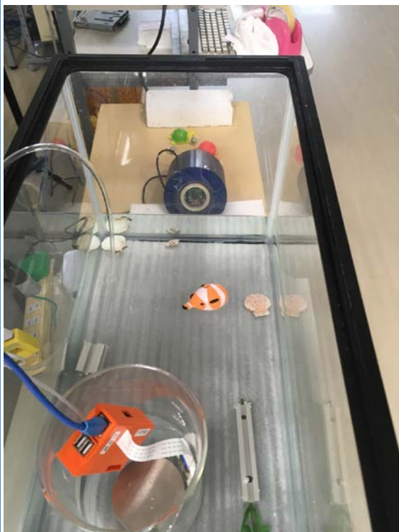
図15 実験装置の構成（カメラは奥側と手前の2個ある）
