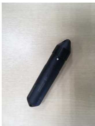
図10 HOBO-U20L 水温測定器
