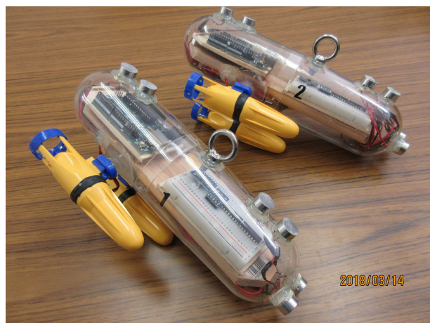
図 3. 藻場探査海中ロボット 左：開発構想図、右：製作中のロボット
