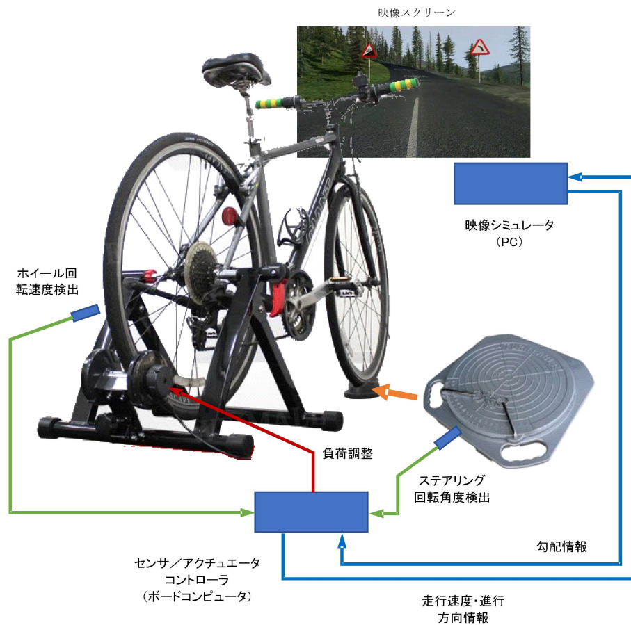
図1 実写型自転車シミュレータの概念図
