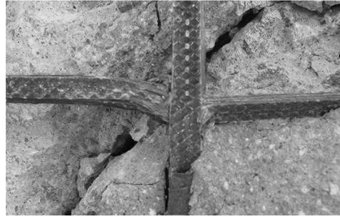
写真-4 CFG 板横筋のせん断変形
