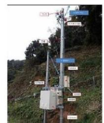
↑ NEC が実用化した土砂崩れデータ計測装置
