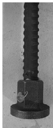
写真-1 SD490 端部の T 形ナット
