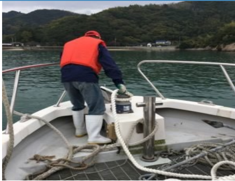
図 7 海底カメラの投入（船首のウインチでゆっくり下ろす）
