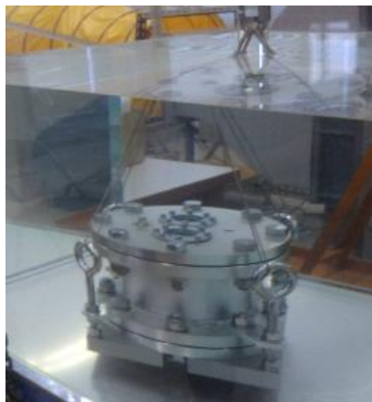
図 1 容器の耐水試験（大型水槽）
