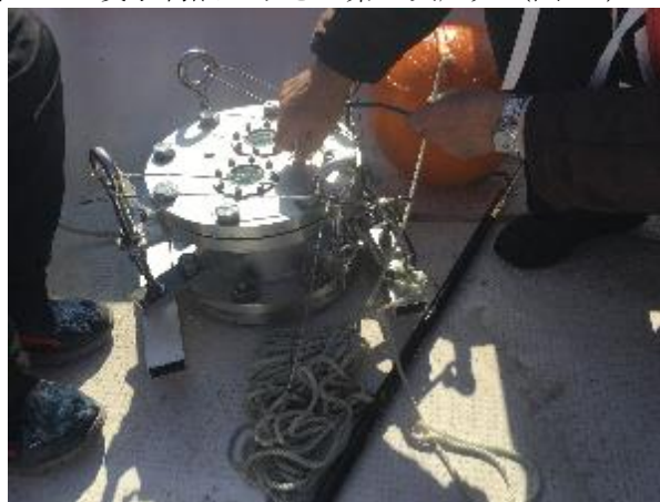
図18 バラストを外して軽量化した海底カメラ
