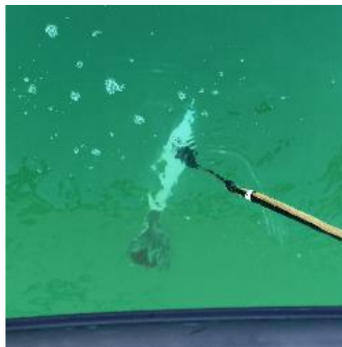
図14 プロペラ流速計の運用
