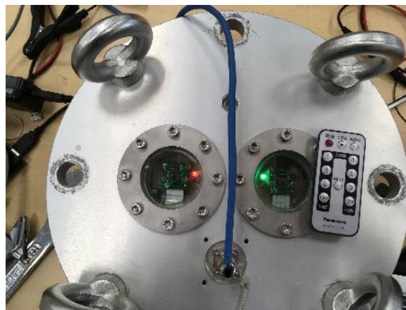
図4 海底カメラ LED とリモコン
