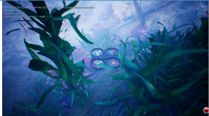
図 2. AirSim によるマルチコプター型水中ロボットの藻場内潜行シミュレーション
