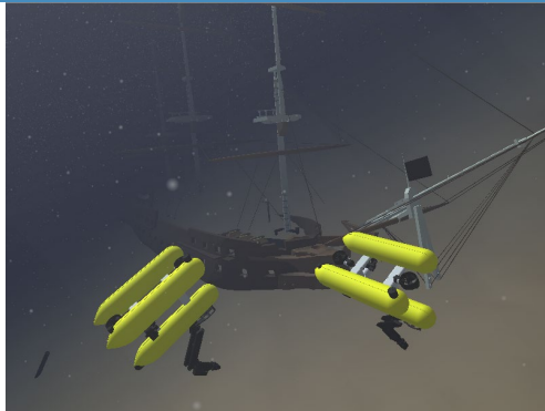
図 1. UWsim による AUV 型水中ロボットのシミュレーション
